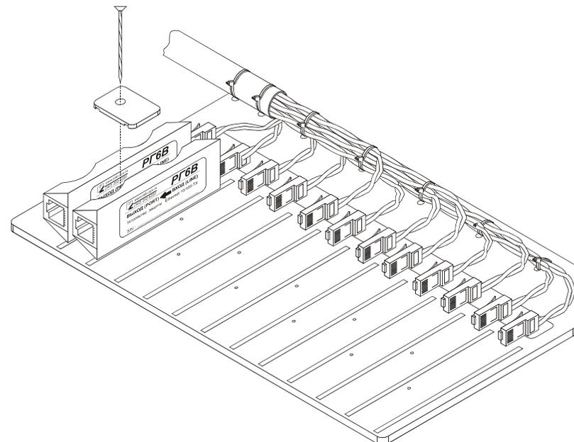
5. Следующие устройства закрепляются по одному. Крепежные планки располагаются в шахматном порядке.
