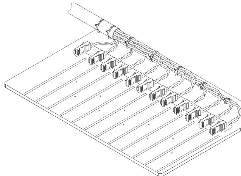
4. Закрепить два крайних устройства при помощи крепежной планки и шурупа. Место заворачивания шурупа обозначено на монтажном основании глухим отверстием.
