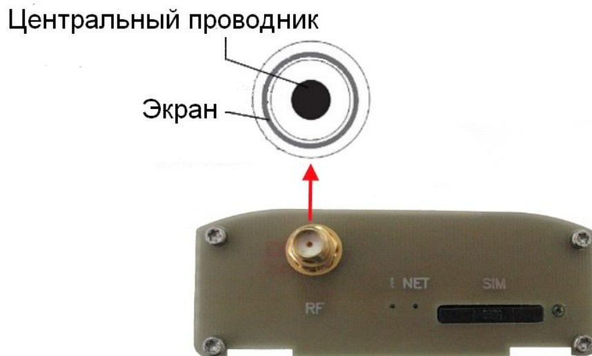
Рисунок 20 „Коннектор антенны (SMA типа „мама“).“
