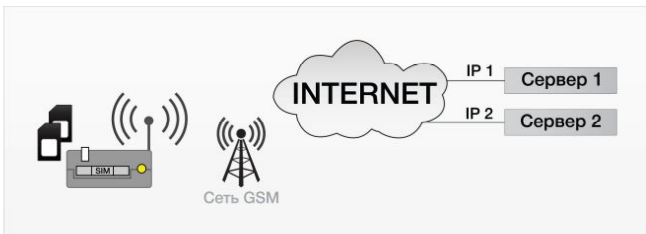
Рис. 4.3 Схема работы с двумя серверами
