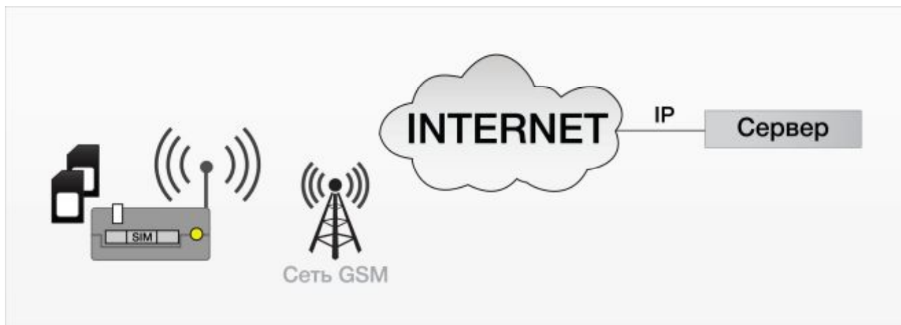
Рис. 4.2 Схема работы с одним сервером без резервирования
