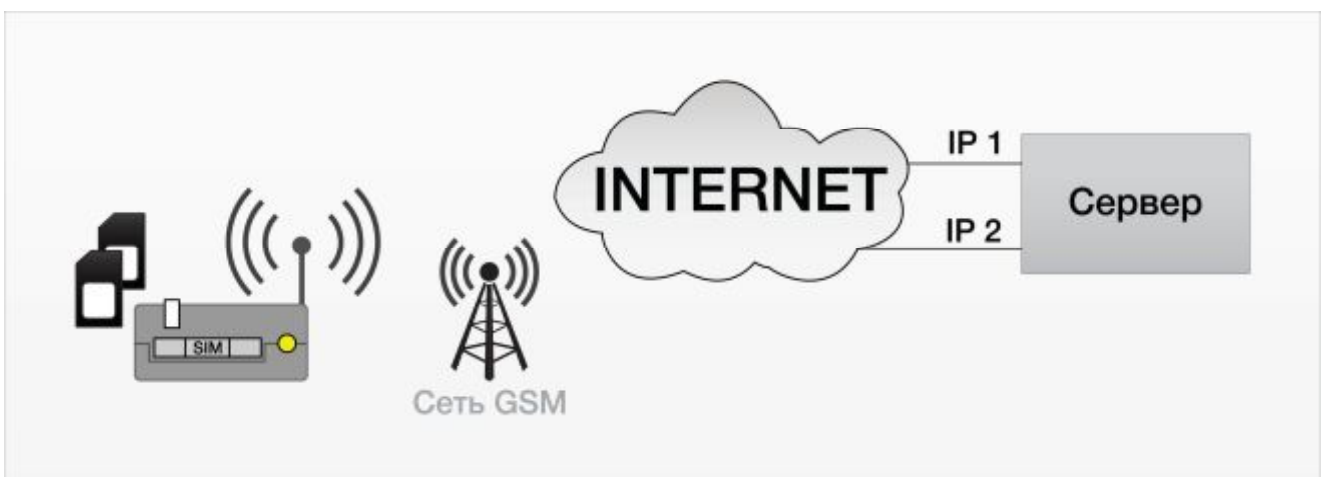
Рис. 4.4 Схема работы с двумя IP-адресами на одном сервере
