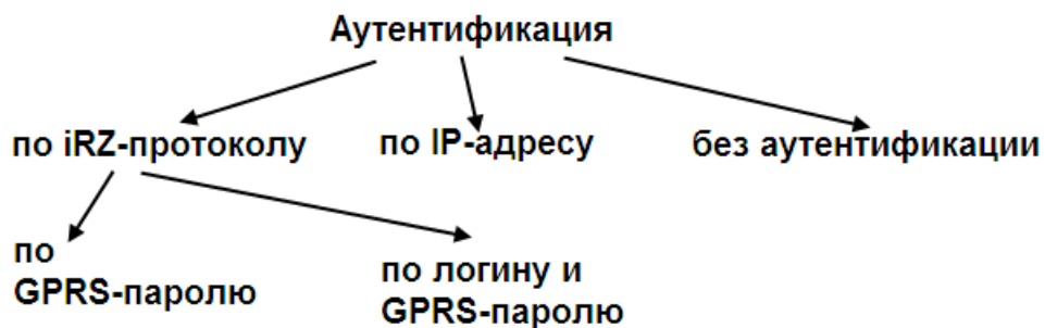
Рис. 4.6 Типы аутентификации клиентов при подключении к модему-серверу
