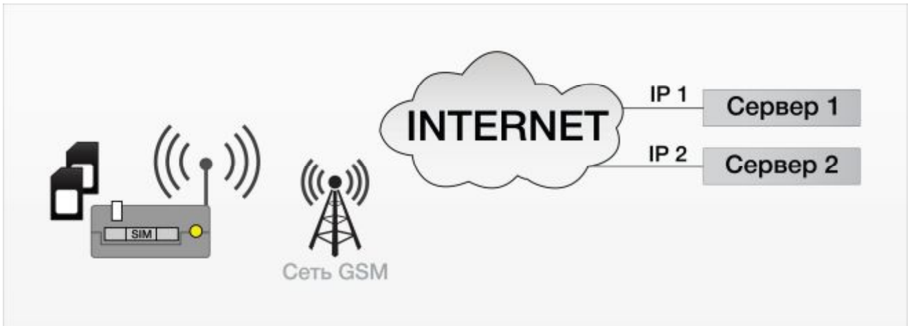
Рис. 4.3 Схема работы с двумя серверами
