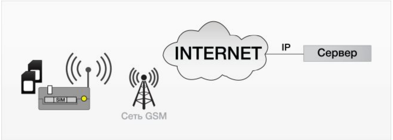
Рис. 4.2 Схема работы с одним сервером без резервирования
