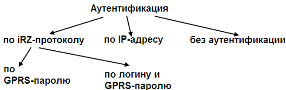
Рис. 4.6 Типы аутентификации клиентов при подключении к модему-серверу
