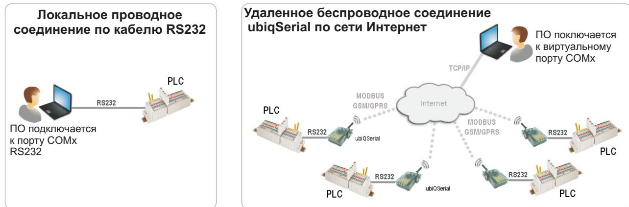
Рис. 2 – Пример удаленной виртуальной последовательной линии связи для прошивки ПЛК
