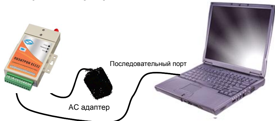
Рисунок 5 Соединение устройства Позитрон EC232(485) кабелем для конфигурирования
